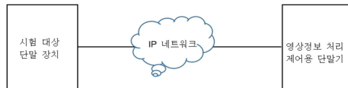
그림 47 — 직접 접속 방식의 영상정보처리기기 비밀번호 시험 구성도
